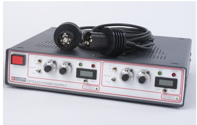
Figura 7. Fuente de alimentación OptoLed junto dos emisores LED. Se observan dos paneles frontales independientes para el ajuste de la corriente suministrada a cada LED. Dispone de un interruptor para seleccionar entre iluminación continua o pulsada, y otro para seleccionar conmutación manual o controlada por una señal externa. También dispone de una pequeña luz verde para indicar que los LEDs están encendidos, y una luz roja para indicar que el sistema de realimentación no es capaz de evitar la saturación de los LED y es necesario disminuir la potencia suministrada manualmente.
