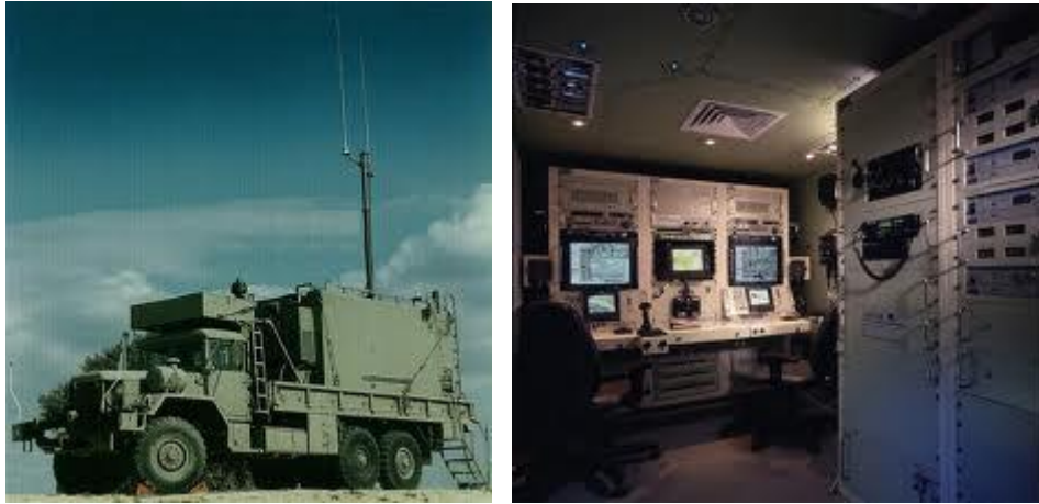
Figura 28: (a) GCS UAV Hermes 450 (b) Interior de GCS UAV Hermes 450
